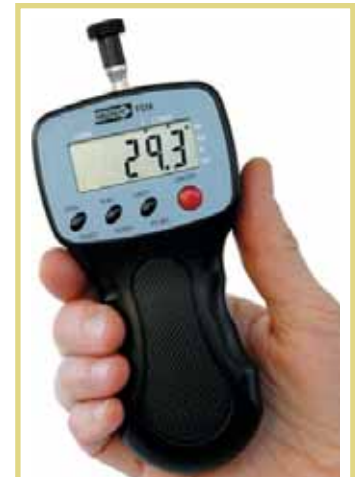
Рис. 1. Цифровой альгометр, модель FPX-50 (Wagner Instruments, США); единица измерения – Ньютон (Н)
